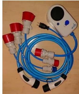
Abbildung 7: Das „Schweizer Taschenmesser“ im Bereich Elektromobilität: ein mobiles Ladegerät mit Kabeln und Adaptern
