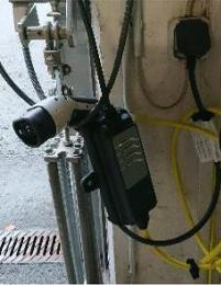
Abbildung 1: Laden zu Hause mit In-Kabel-Kontrollbox (ICCB)
