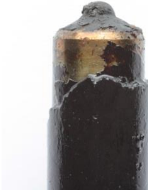
Abbildung 30: Injektorspitzen des Abgasstufe-III B-Traktors nach ca. 1.200 Betriebsstunden mit Rapsölkraftstoff
