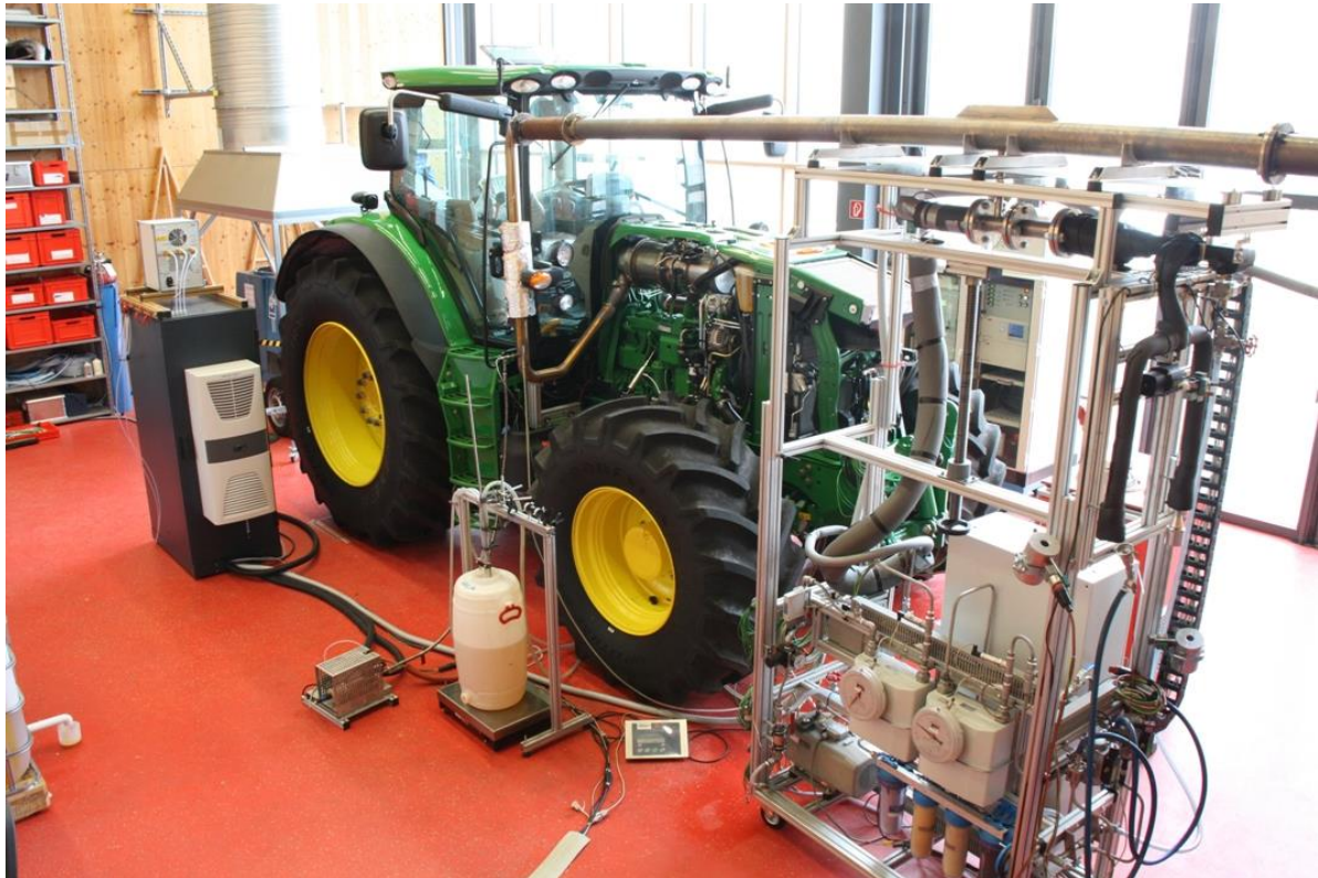
Abbildung 22: Versuchstraktor auf dem TFZ-Traktorenprüfstand (Quelle: TFZ)
