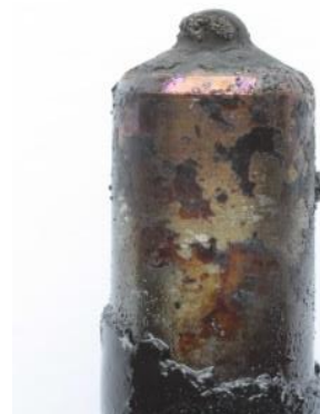
Abbildung 30: Injektorspitzen des Abgasstufe-III B-Traktors nach ca. 1.200 Betriebsstunden mit Rapsölkraftstoff
