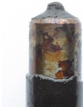
Abbildung 30: Injektorspitzen des Abgasstufe-III B-Traktors nach ca. 1.200 Betriebsstunden mit Rapsölkraftstoff
